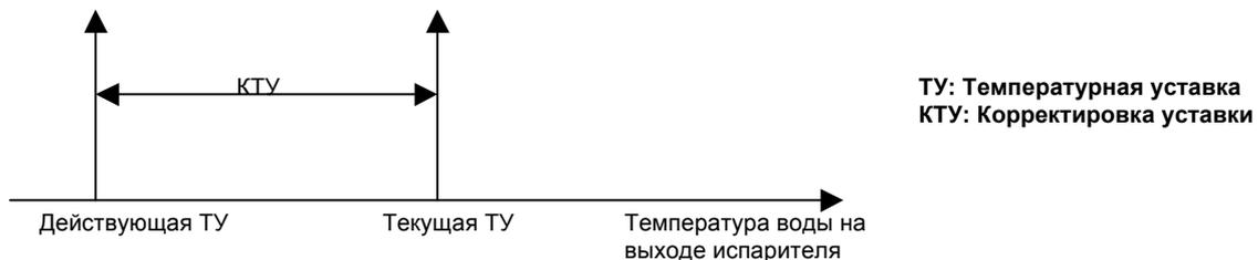
Для машин типа ВОЗДУХ-К-ВОДЕ (конфигурации 31 и 32) величина снижения, применяемая к действующей температурной уставке, рассчитывается самой функцией в зависимости от значения наружной температуры, измеряемой датчиком включаемым в состав системы специально для этой цели.
